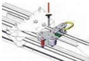
2) トロリーを開くために下部プレートを回転させ、固定ベグを持ち上げます。
