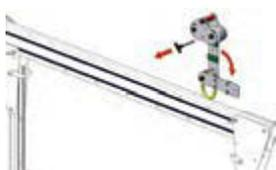
12) トロリープレートを閉じてビームを包み込み、航空機/ボールロックピンを挿入します。ピンがしっかりと穴を通っていることを確認してください。
